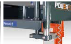
Hebefunktion blockiert bei nicht geschlossenem Einstieg
